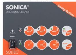
**Serie ETH** è una versione con controllo elettronico del tempo di lavaggio e della temperatura. La serie ETH è equipaggiata con un microprocessore che gestisce le singole funzioni tramite un pannello di comando impermeabile. **Sweep System** di serie.
