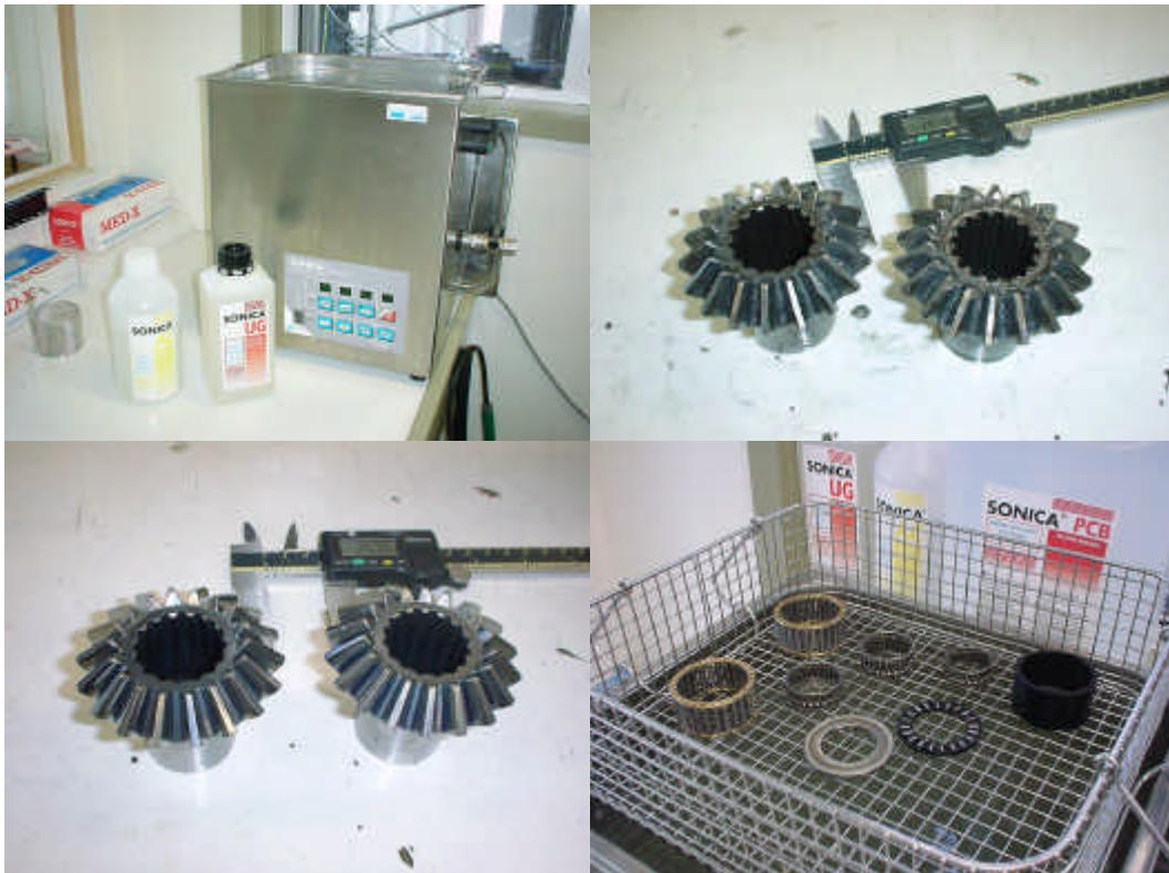
Il metodo NDT (non destructive testing) costituisce una parte importante del nostro processo di ricerca e sviluppo. I componenti selezionati per il test di valutazione sono risultati eccezionalmente puliti e liberi da contaminazione dopo il lavaggio ad ultrasuoni.
