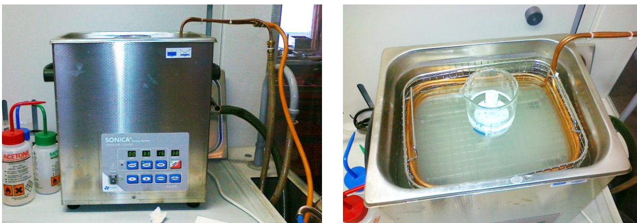
Figura 2 Lavatrice ad ultrasuoni SONICA 3300EP e serpentina di raffreddamento collegata alla rete idrica
