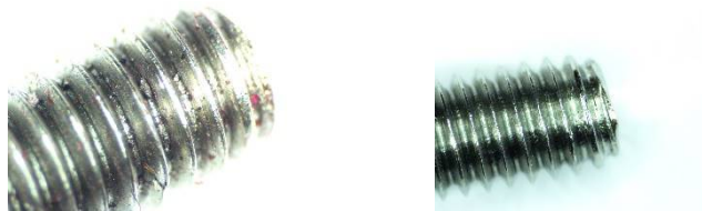
A Sinistra, particolare di una vite post lavorazione. A destra, il risultato dopo la pulizia con il prodotto SONICA ML
