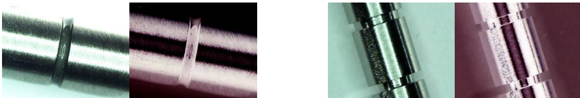
A Sinistra, particolare di un albero lubrificato con grasso non qualificato ad uso nel vuoto. A destra, lo stesso particolare dopo la pulizia con il prodotto SONICA ML
