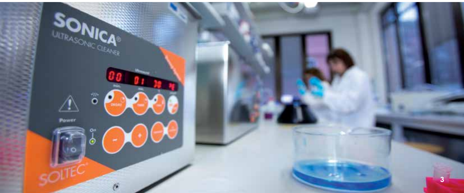
Figura 3 - Bagno ad ultrasuoni Sonica 3200 EP S3 all'interno di uno dei laboratori dell'Istituto italiano di tecnologie di Milano
